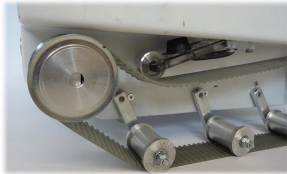
Abbildung 37: Raupen mit Spannradkonstruktion
