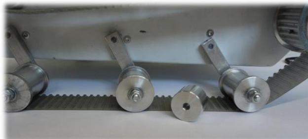
Abbildung 38: Vergleich alte / neue Laufräder
